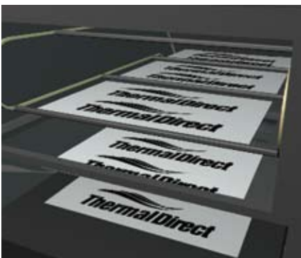
Nach wenigen Druckbogen ist der Hintergrund frei gelaufen und die korrekte Farbdichte erreicht.
