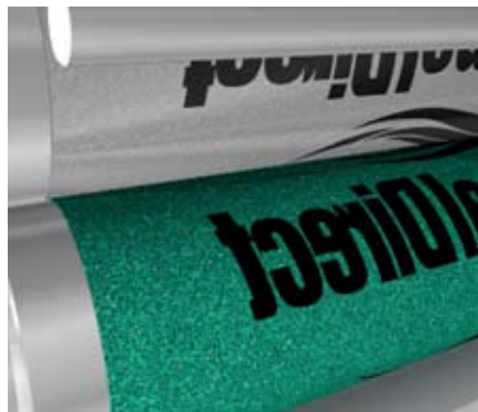
Das Feuchtmittel sowie die Zügigkeit der Farbe gewährleisten die Übertragung der abgelösten Schicht auf das Gummituch und somit auf die ersten Druckbogen.
